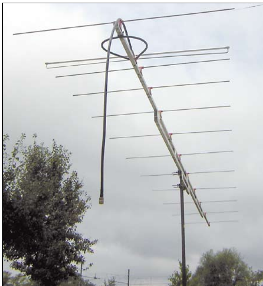
La nuova versione della mitica 12 elementi K1FO; un esempio di quanto un buon progetto iniziale, possa essere facilmente adattato alle nuove esigenze, anche da non professionisti!
